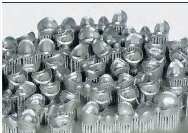
Рис. 4. В последние 15 лет лазерное спекание металлов получило распространение для изготовления каркасов коронок и мостов
