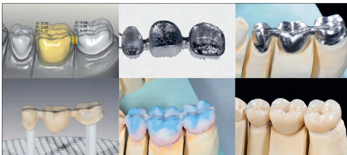
Рис. 6. Шероховатость поверхности, созданная в процессе изготовления хромокобальтового каркаса, облегчает нанесение на него керамики (EOS CobaltChrome SP2)
